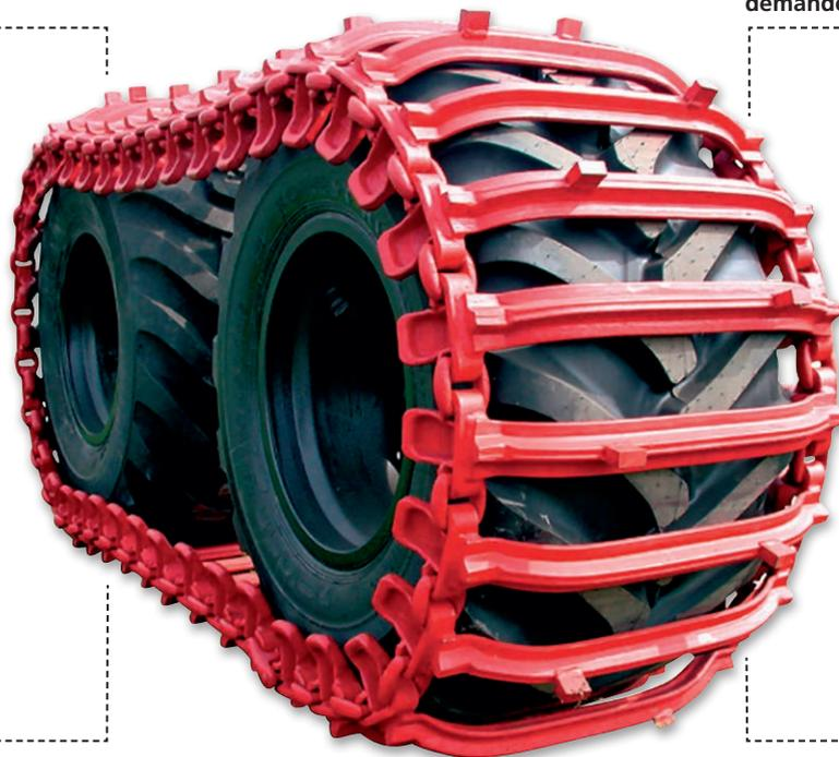
Protection du pneu grâce à une adaptation optimale à son profil. Long cycle de vie dû à fabrication en acier bore endurci et articulations renforcées
